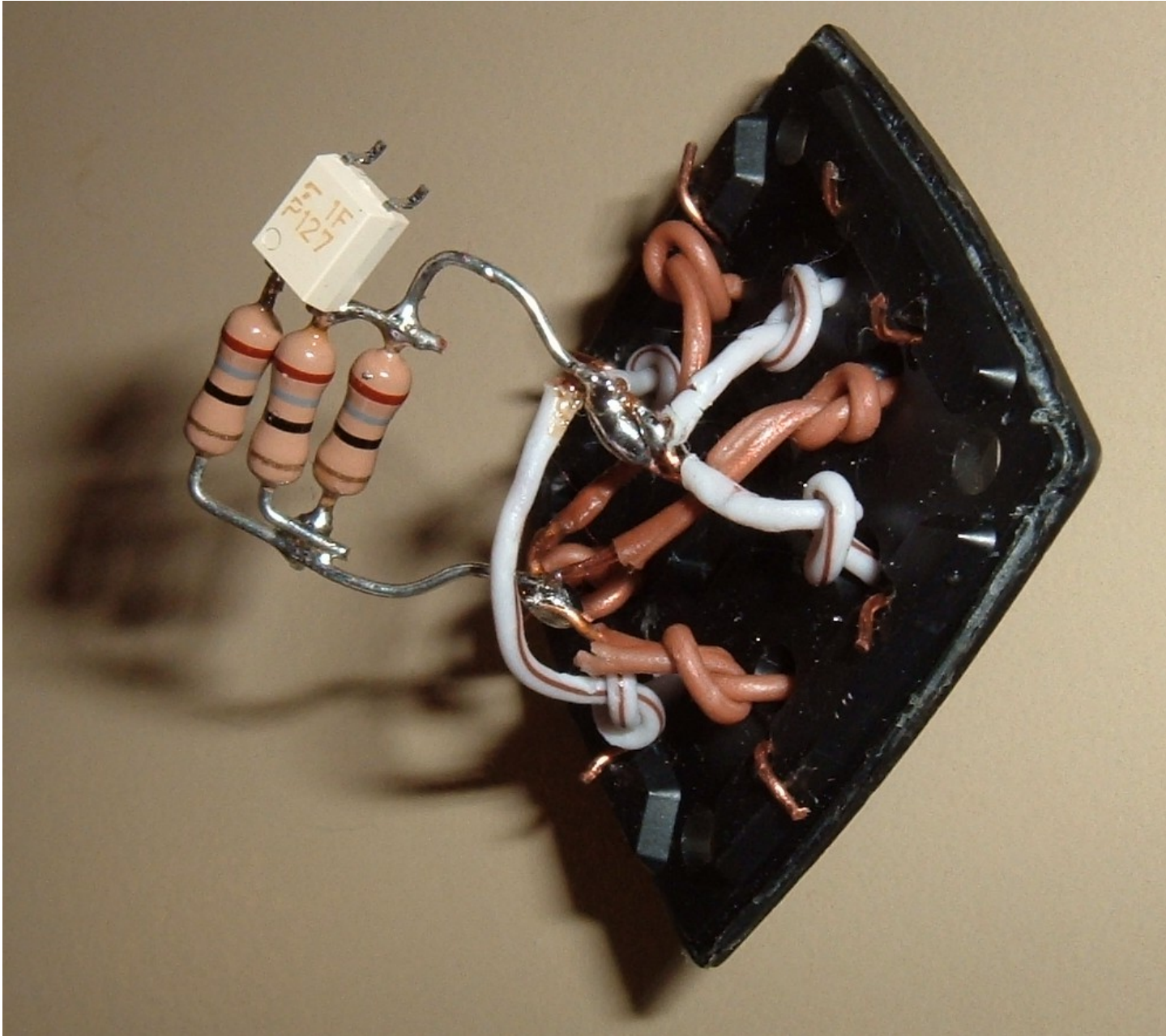
Composants soudés au socle
